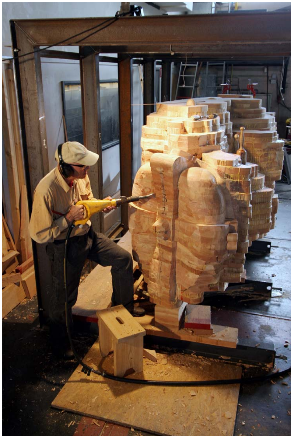
Joop van Esch werkt met een lichtgewicht beitelhamer van de RRD-serie: „Omdat zijn slagkracht zo fijn gedoseerd kan worden en de hamer zo goed in de hand ligt, kan ik de contouren van de leeuw heel precies uit het hardhout snij- den.“ (Bron: Atlas Copco Tools)
