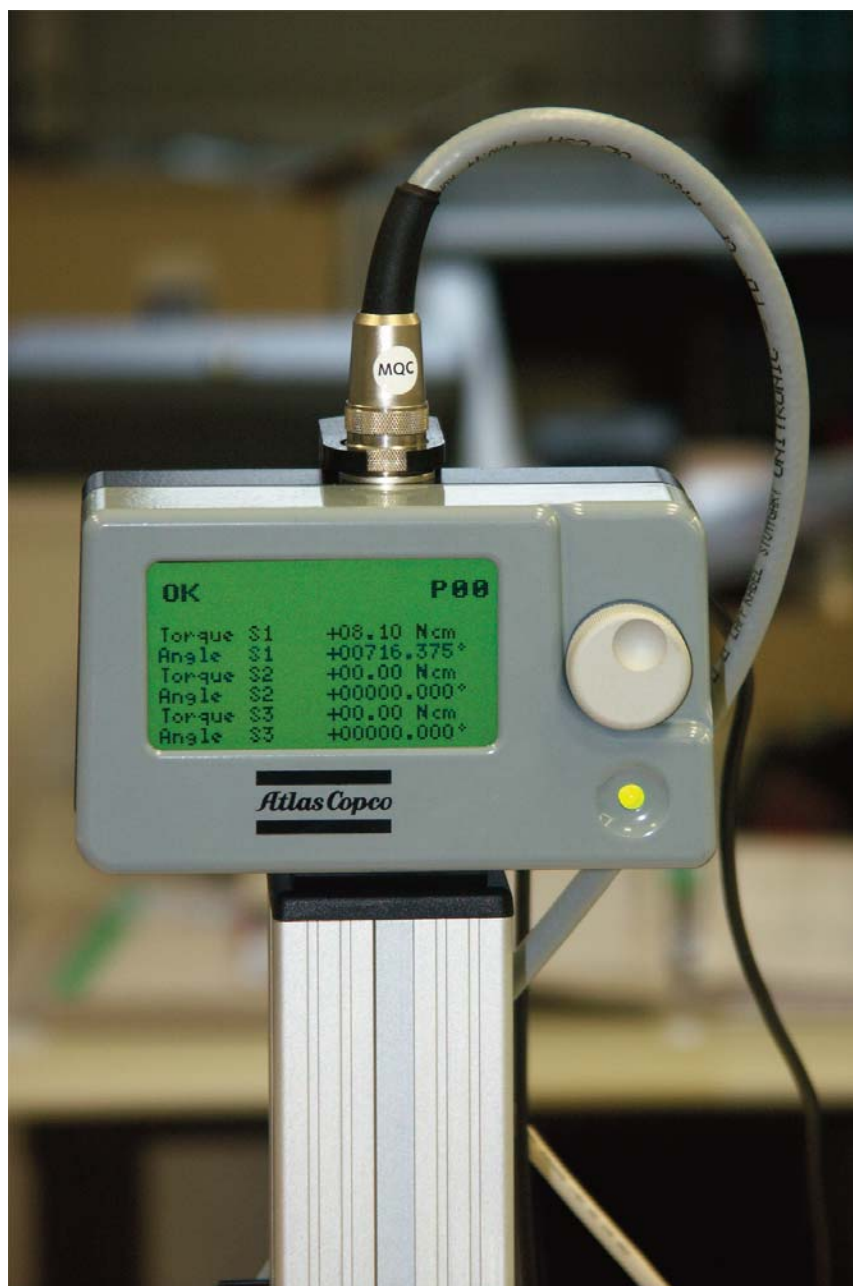
De Acta-MT-schroevendraaierbesturing zit boven op de houder van de Micro-Torque-sensorspindel. Zij bestuurd deze door middel van de software „ToolsTalk Analysis“ voor de bevestigingsanalyse. (Foto: Atlas Copco Tools)
