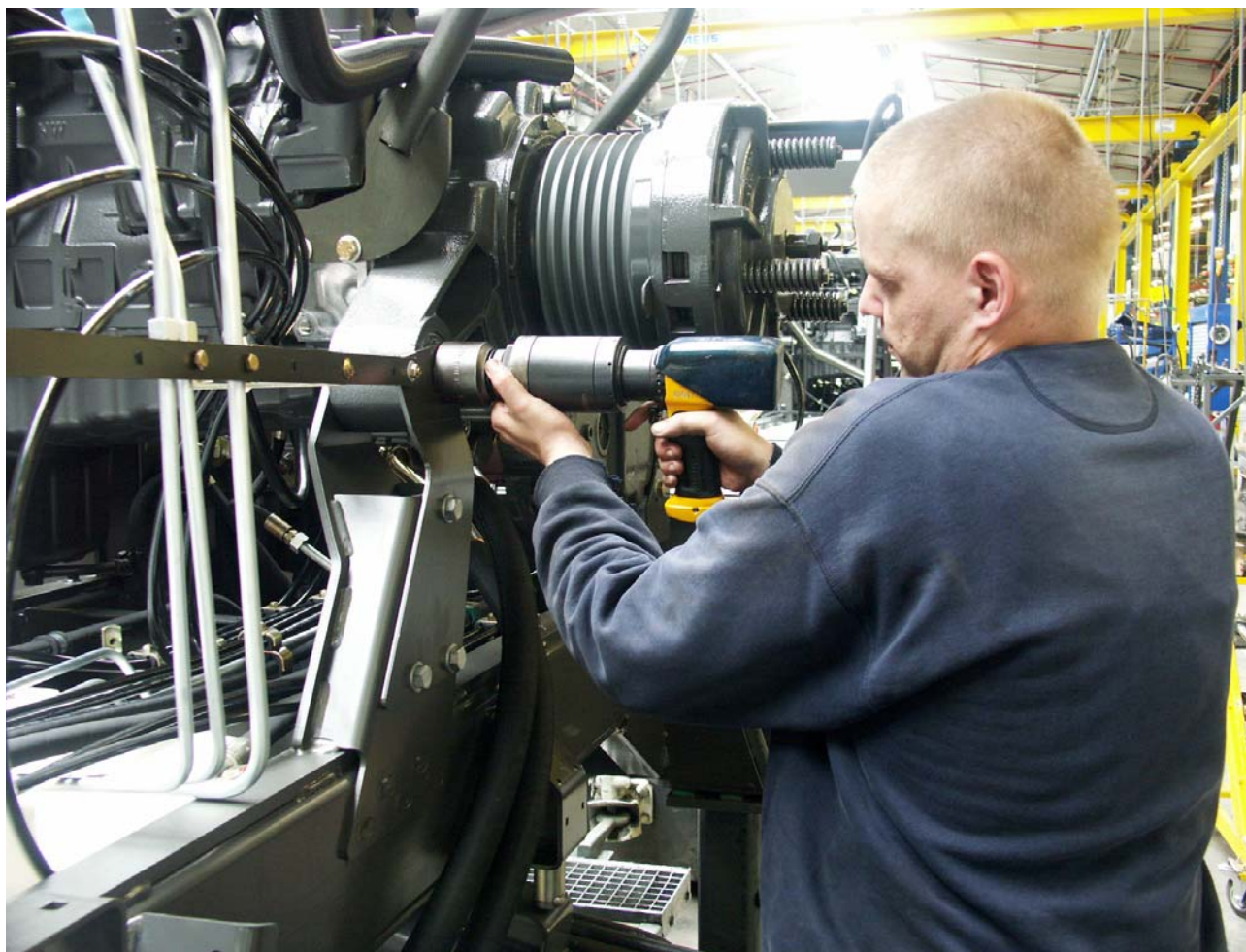
Om de motorsteun te fixeren worden de moeren met 1300 Nm aangetrokken. (Bron: Atlas Copco Tools)
