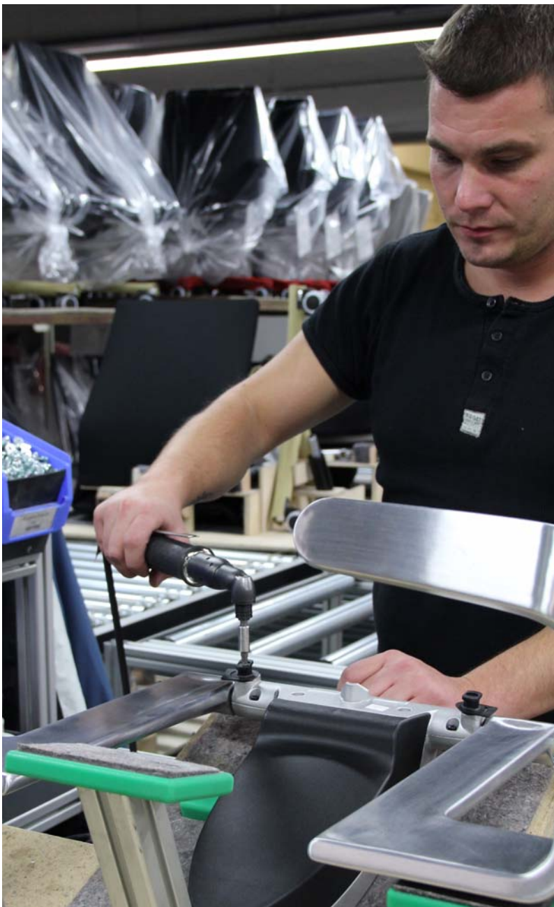
Montage van de beide schroeven met de zelfde machine aan het „kniegewricht“, waarbij geen gradiëntstrategie nodig is. (Foto: Atlas Copco Tools)
