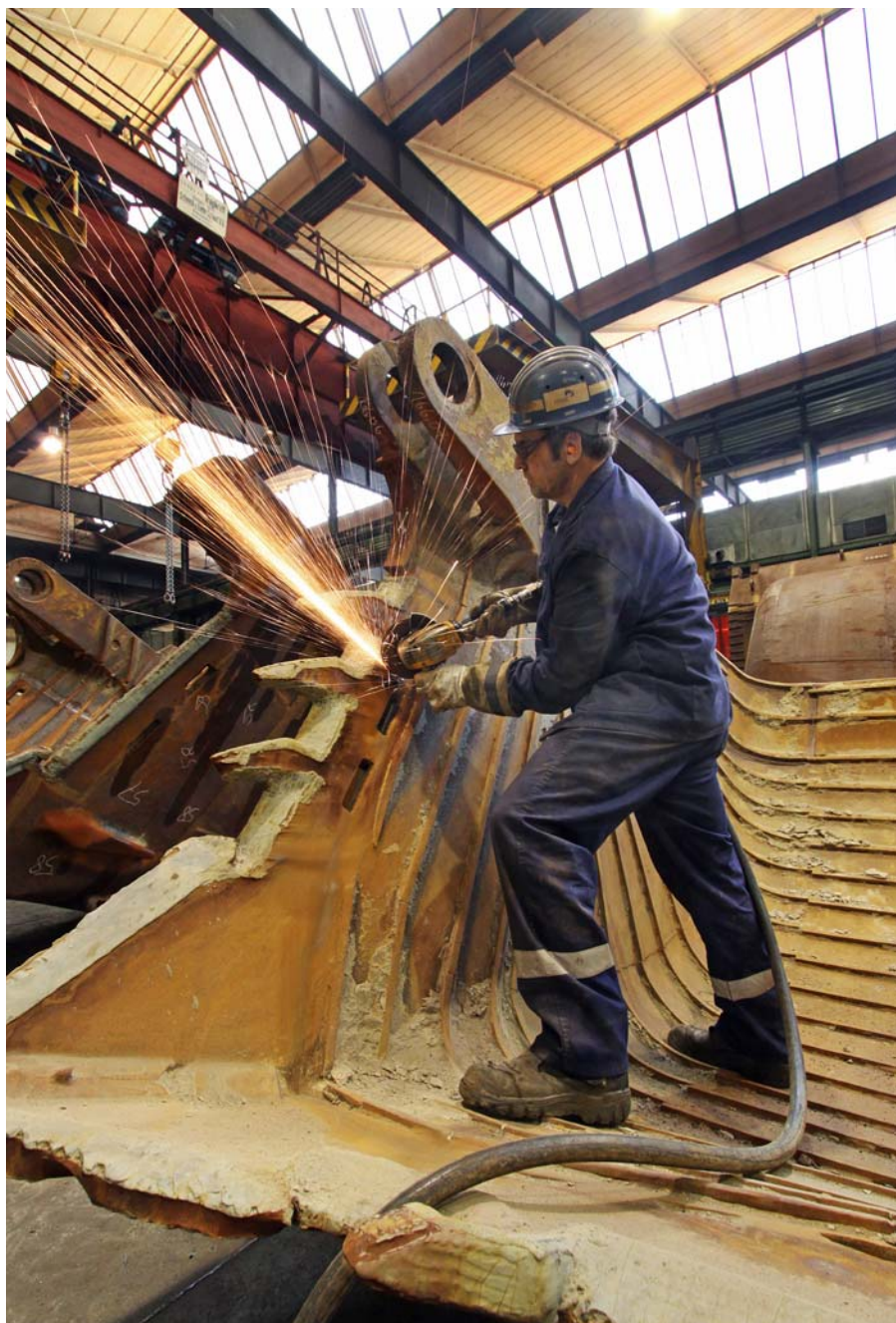
Na vele jaren gebruikt te zijn was dit scheprad versleten. Met de turboslijper GTG 40 krijgt ze een verjongingskuur. (Foto: Atlas Copco Tools)
