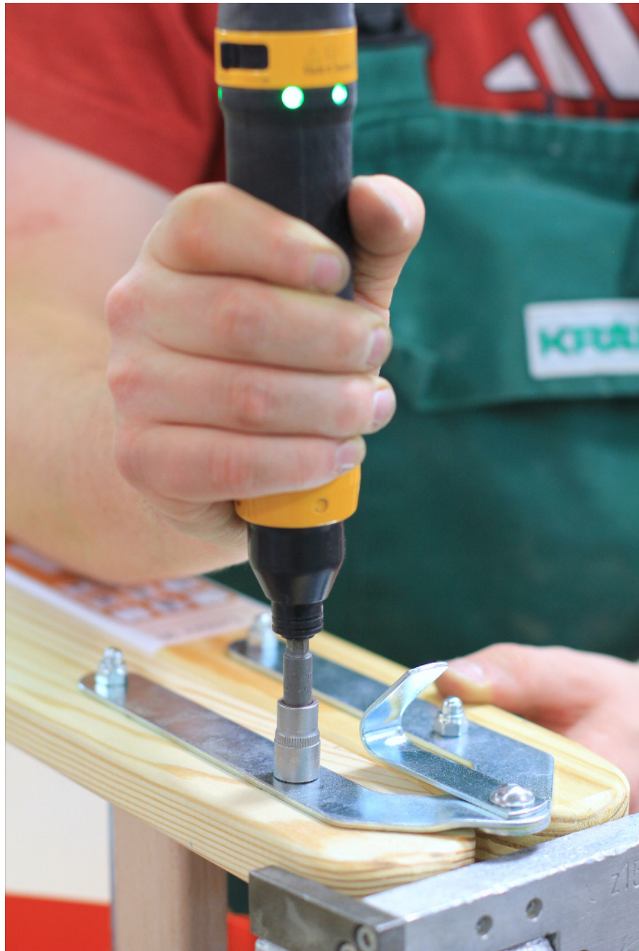
Vier schroeven rechts en vier links houden de beide ladderbomen van de houten trapladders met sporten veilig bij elkaar. (Foto: Atlas Copco Tools)
