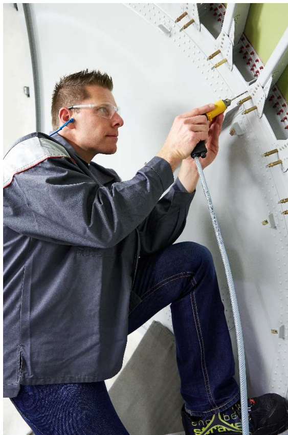
Bij Ruag in Gilching worden per dag ongeveer 120.000 gaten met de hand geboord. Ze moeten ook nog verzonken en geklonken worden. Op de foto een LBB-boormachine van Atlas Copco Tools. (Bron: Atlas Copco Tools)
