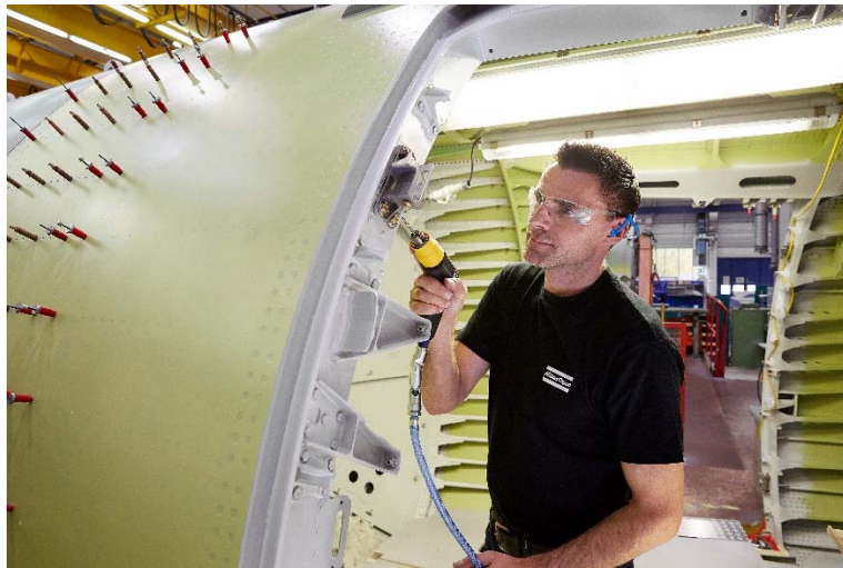
De LBB-boormachines zijn door Atlas Copco Tools speciaal voor de vliegtuigbouw ontwikkeld. (Bron: Atlas Copco Tools)
