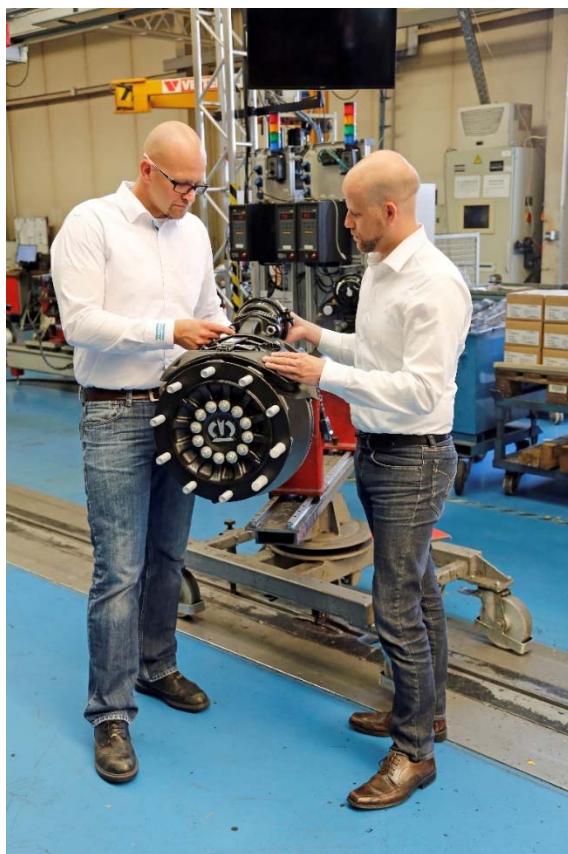
Gedetailleerde expertise: Remaggregaat en naaf-flens-systeem worden met schroeftechniek van Atlas Copco gemonteerd. Op de achtergrond de besturingen van de verschillende elektrische moeraanzetters Tensor. (Foto: Atlas Copco Tools)
