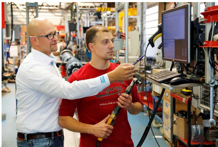
Bespreking van de actuele schroefresultaten op het beeldscherm: De scholing van de bedieners van de computergestuurde schroefsystemen van Atlas Copco neemt in de regel zelfs bij complexe onderdelen maar enkele uren in beslag. (Foto: Atlas Copco Tools)
