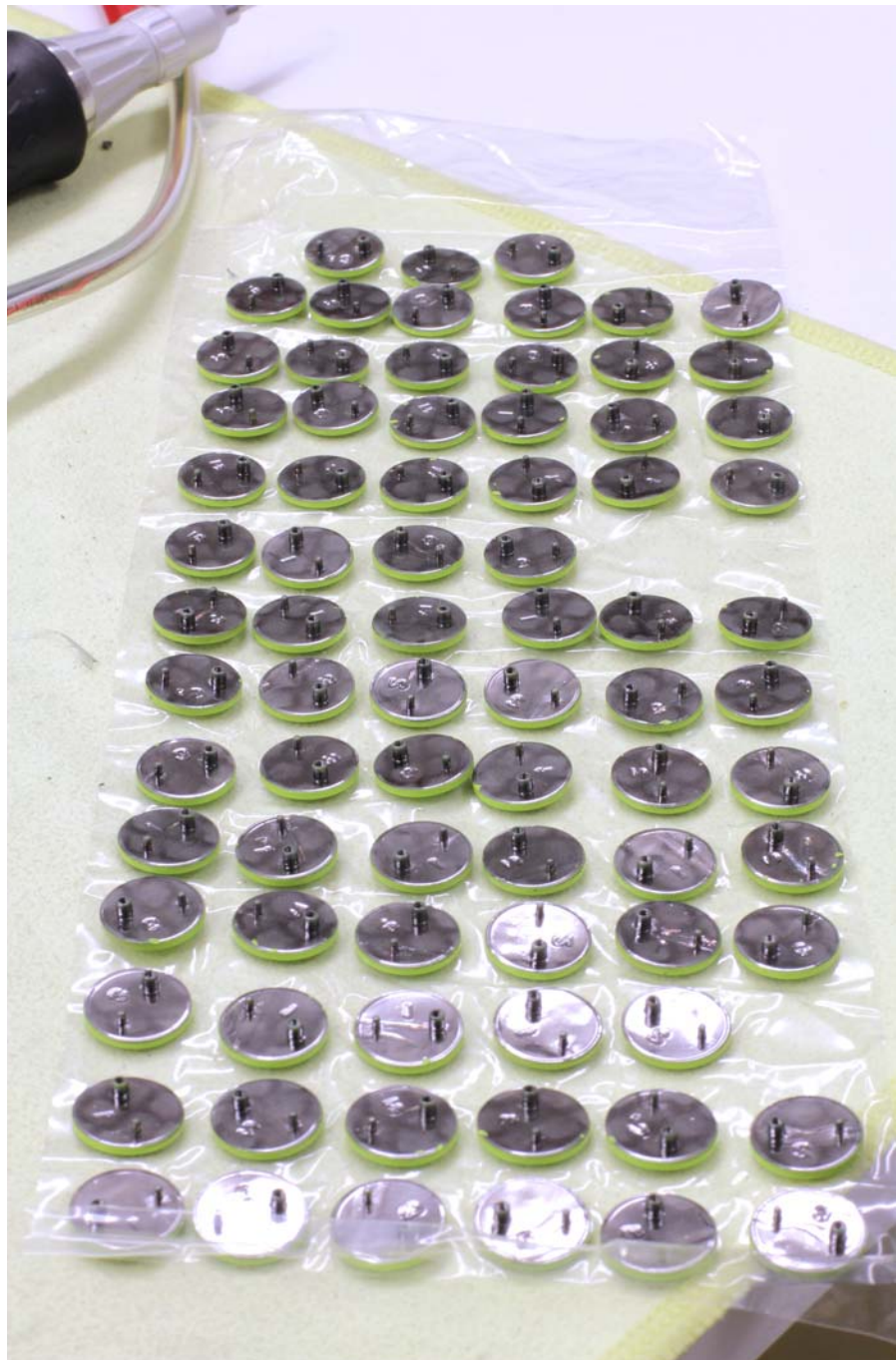
Deze kunststof logo's worden in de beugels geplaatst en van achteren (de hier zichtbare zijde) met een kleine schroef met sleufkop bevestigd. (Foto: Atlas Copco Tools)
