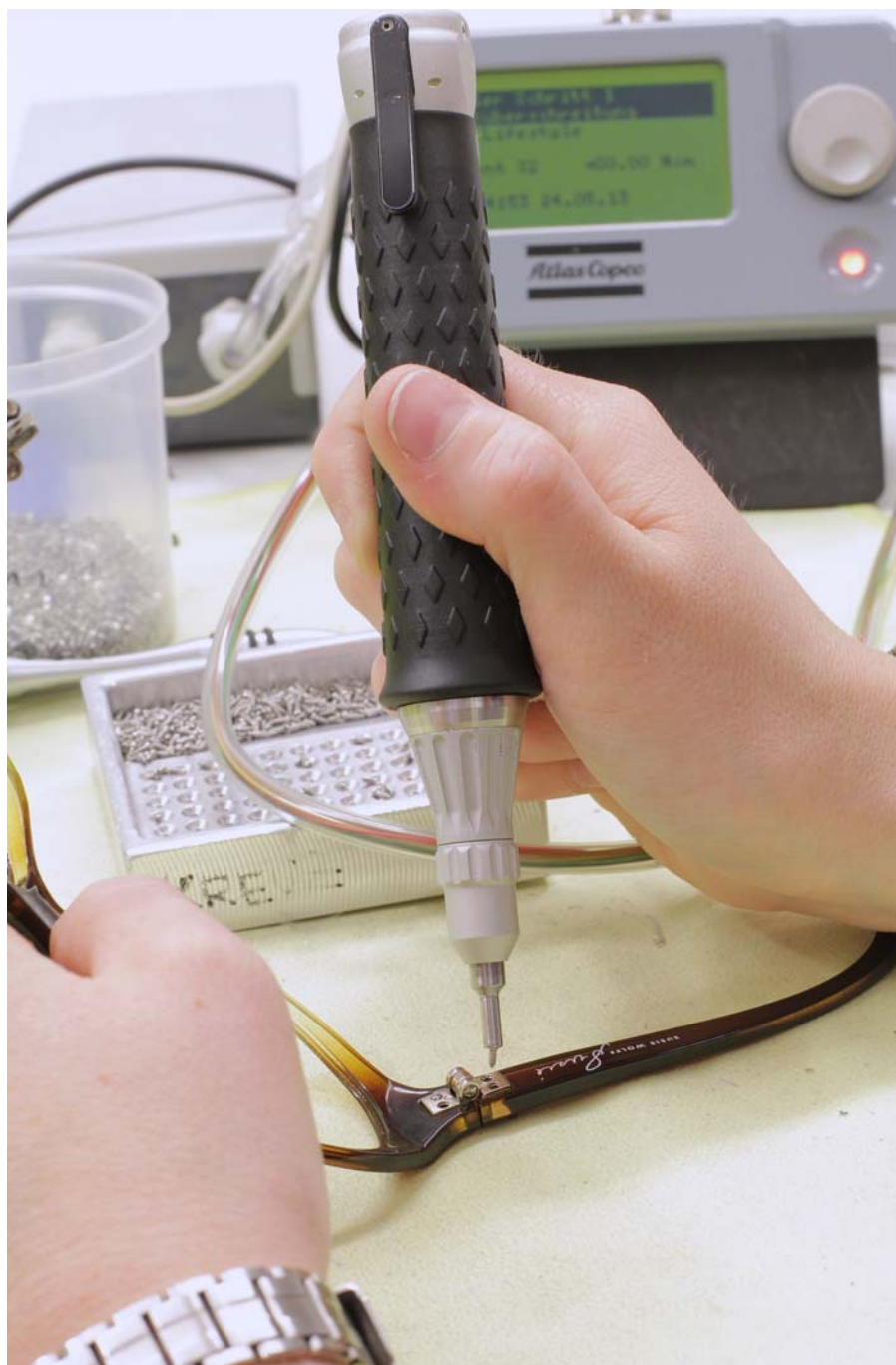
De Lifestyle-modellen hebben per beugel vier zelftappende schroeven. (Foto: Atlas Copco Tools)
