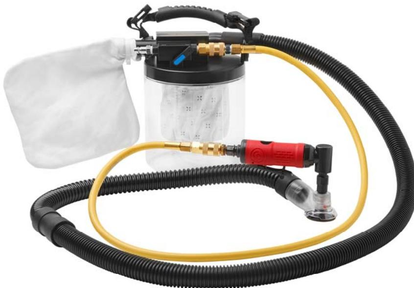
*Der tragbare, mit Druckluft betriebene Spänesauger CPA5000 wird über denselben Schlauch versorgt wie die pneumatische Bohr- oder Schleifmaschine, an deren Arbeitsplatz er eingesetzt wird. (Bild: Chicago Pneumatic)*
