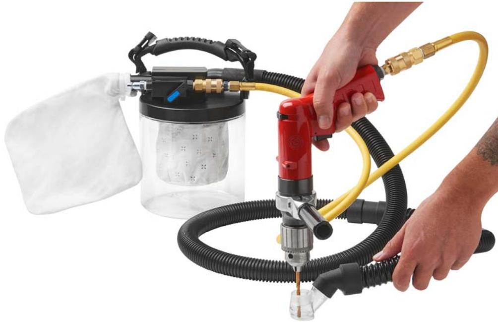
*Der Spänesauger kann direkt an Bohr- und Schleifmaschinen angeschlossen werden. Es stehen verschiedene Abdeckungen zur Verfügung, die wie der Auffangbehälter aus transparentem Lexan gefertigt sind. Das macht sie nahezu unzerstörbar und bietet freie Sicht auf Bauteil und Werkzeug.
