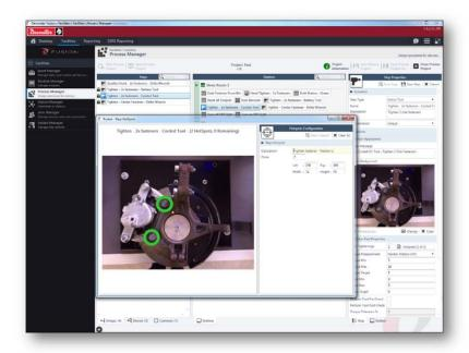
PivotWare visualisiert die Arbeitsschritte und hilft dadurch, Montagefehler zu vermeiden. So können die jeweiligen Schraubstellen im Bild markiert werden (hier grün angedeutet). Die jeweils als nächstes anstehende Schraubstelle kann durch einen pulsierenden gelben Kreis angezeigt werden. (Bild: Desoutter)
